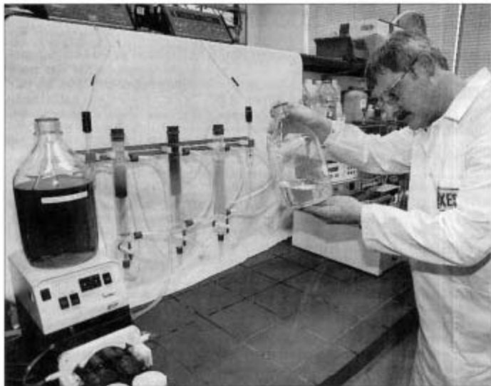
In mehreren Filterschritten werden dem verflüssigten dunklen Rohzucker alle Fremdstoffe entzogen. Zuletzt hält Hans-Karl Soest einen Behälter mit glasklarem Flüssigzucker in der Hand. (Foto: Sevensch)
